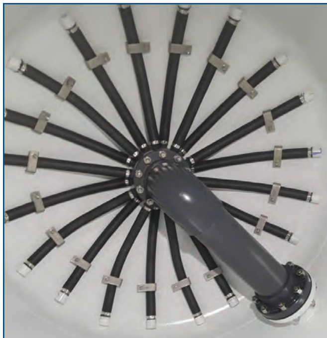
Desagüe inferior con centro radial de PVC cédula 80 con conexión de pared lateral
