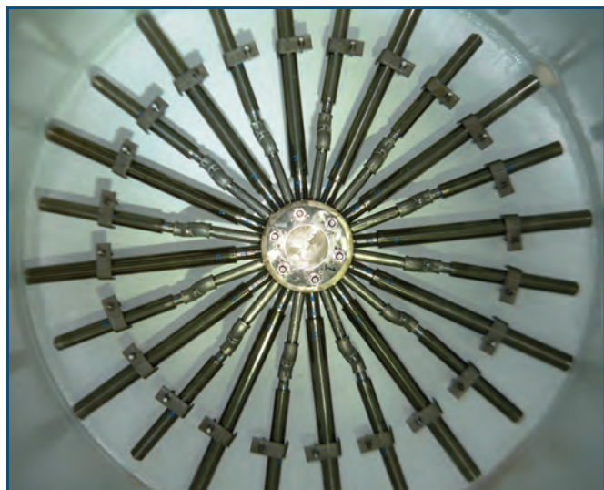
Diseño común de entrada/salida de acero inoxidable 304 para lecho compacto
